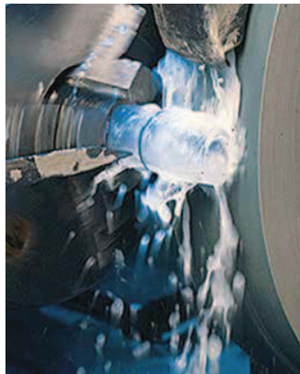
NS-Kerne werden auf halbautomatischen Rundschleifmaschinen weiterbearbeitet.
