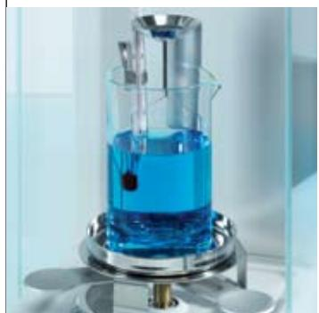
Специальная приставка для определения плотности позволяет легко измерить плотность твердых и пористых тел, а также жидкостей и пастообразных веществ.
