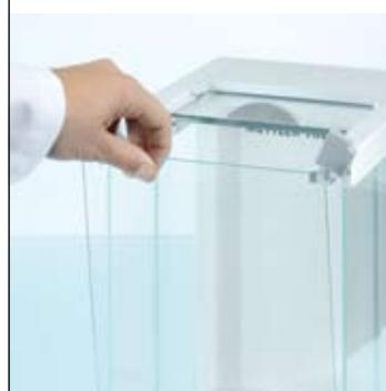
Ветрозащитный кожух аналитических весов MS легко разбирается — все дверцы и панели можно быстро снять, вымыть и поставить на место.
