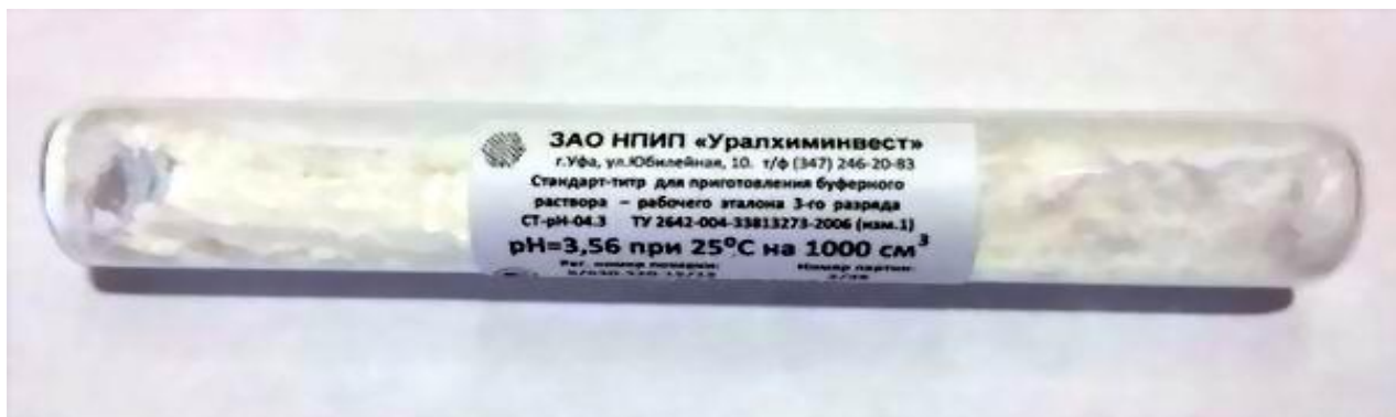
Рисунок 1 - Стандарт-титр для приготовления буферного раствора - рабочего эталона рН 3-го разряда СТ-рН-04.3
