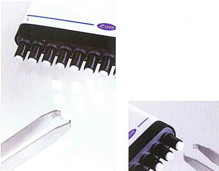
Рис. 23. Установка конических фильтров в дозатор Sartorius
