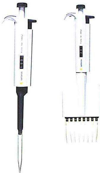
Рис.26. Одноканальный и восьмиканальный механический дозатор Sartorius Proline
