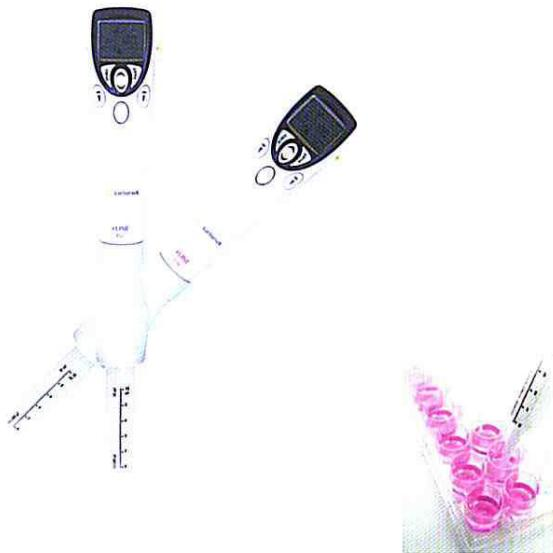
Рис. 24. Работа с дозатором типа позитивного вытеснения (степпером). На фото представлен дозатор Sartorius eLINE dispenser.
