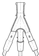
Является соединительным элементом и используется в комплекте с алонжем АКП при сборке различных приборов, аппаратов и установок.
