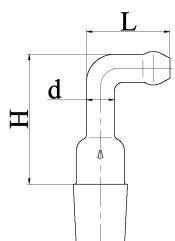
Соединительные элементы с взаимозаменяемым конусом. Применяется при работе приборов, аппаратов и установок.
