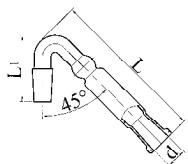
Пример обозначения: ТРУБКА TX<45°-14/23
