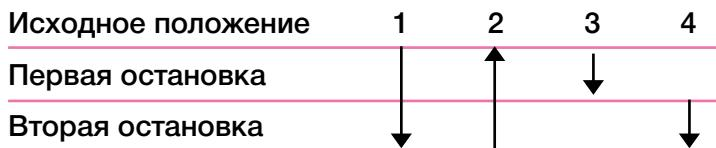
«Да»: Дозирование образцов или реагентов без смешивания с другой жидкостью.
