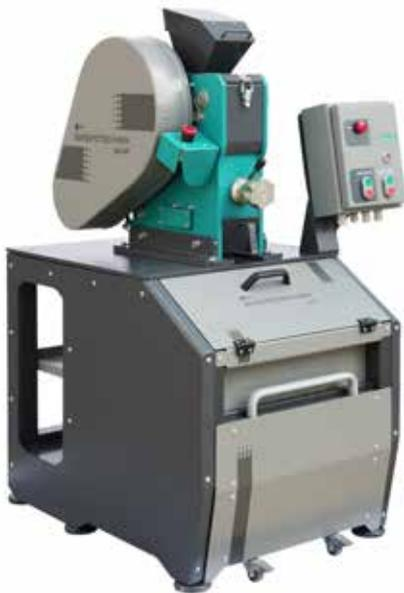
Дробильно-сократительный агрегат на базе ЩД 6М
