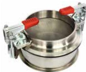
Сито **С 12P** с сеткой из нержавеющей стали на поддоне Ø120 мм
