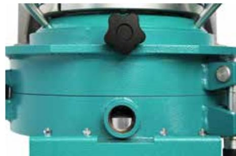
Отверстие для контроля зазора между дисками
