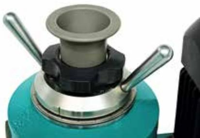
Устройство регулировки зазора между дисками
