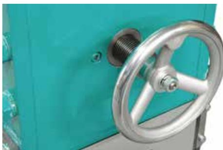
Устройство регулировки зазора между щеками ЩД 15
