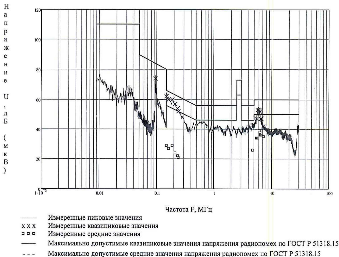
Рисунок 2 - Наибольшие зарегистрированные пиковые, квазипиковые и средние значения напряжения радиопомех U в дБ (мкВ), создаваемые изделием в цепи электропитания переменного тока 220 В, 50 Гц, и норма квазипиковых и средних значений по ГОСТ Р 51318.15.
